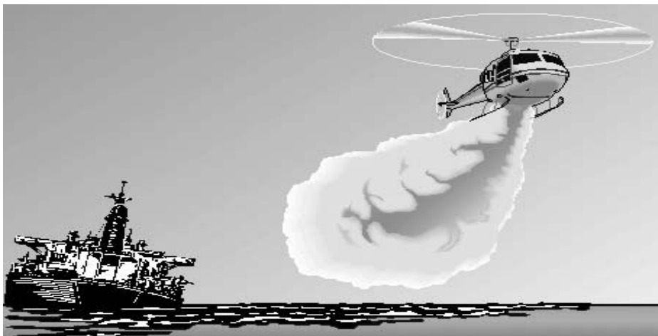
Figura 6 - Sistemas de aplicação de dispersantes adaptados para helicópteros
